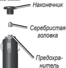
2. Снимите наконечник, серебристую головку и предохранитель (стеклянный цилиндр с серебристыми контактами на концах).
